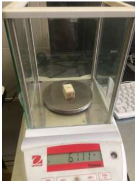
Hình 2: Thí nghiệm xác định trọng lượng riêng và thí nghiệm nén mẫu gỗ
